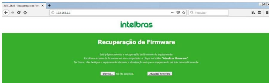
» Selecione o firmware de acordo com seu dispositivo e depois clique no botão Atualizar firmware. O equipamento piscará o LED branco enquanto o firmware é enviado para o produto. Aguarde até que o dispositivo seja reiniciado com LED na cor verde. Com esse processo realizado, seu dispositivo estará pronto para uso novamente.
